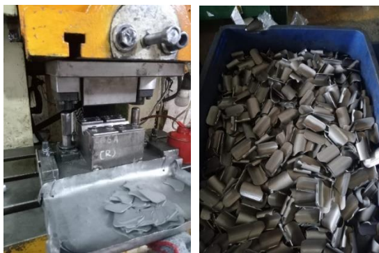
Gambar 4.10 Proses bending dies dan hasil bending dies
