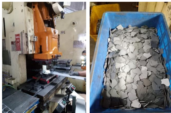
Gambar 4.8 Proses blanking dan hasil blanking
