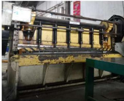
Gambar 3.2 Mesin *Shearing*
