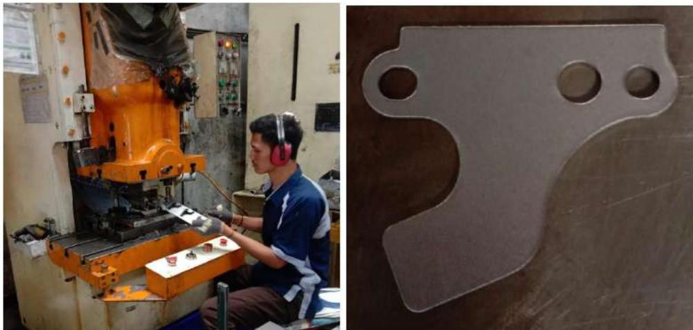
Gambar 4.8 Proses dan Hasil Produksi mesin *stamping* dengan *Compound dies*
