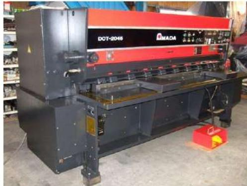
Gambar 2.4 Mesin *Shearing*
