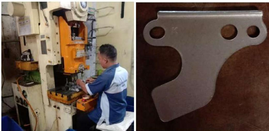
Gambar 4.10 Proses dan hasil mesin *stamping* dengan dan Hasil *Bending*
