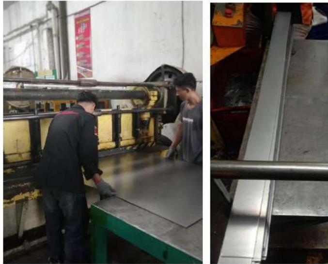
Gambar 4.6 Proses dan hasil pemotongan *plate*
