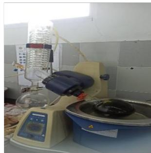
Penguapan ekstrak menggunakan rotary evaporator
