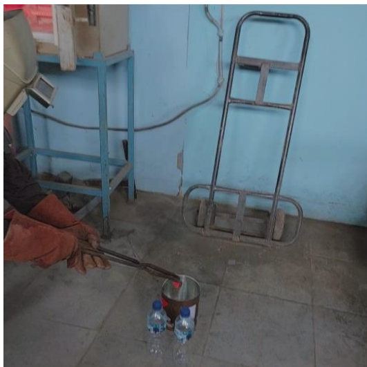
Gambar 3. 17 Proses Quenching (Sumber: Lab. Teknik Mesin UPS)
