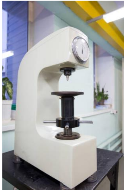
Gambar 3. 9 Mesin Uji Kekerasan Rockwell (Artvent E. T., 2019)
