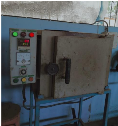
Gambar 3. 15 Tungku Hardening (Sumber: Lab. Teknik Mesin UPS)
