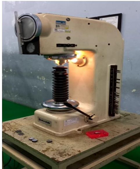
Gambar 3. 18 Mesin Rockwell (Sumber: Lab. Bahan Teknik UGM)
