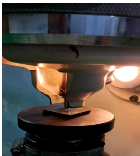
Gambar 3. 19 Meja Pengujian Rockwell (Sumber: Lab. Bahan Teknik UGM)
