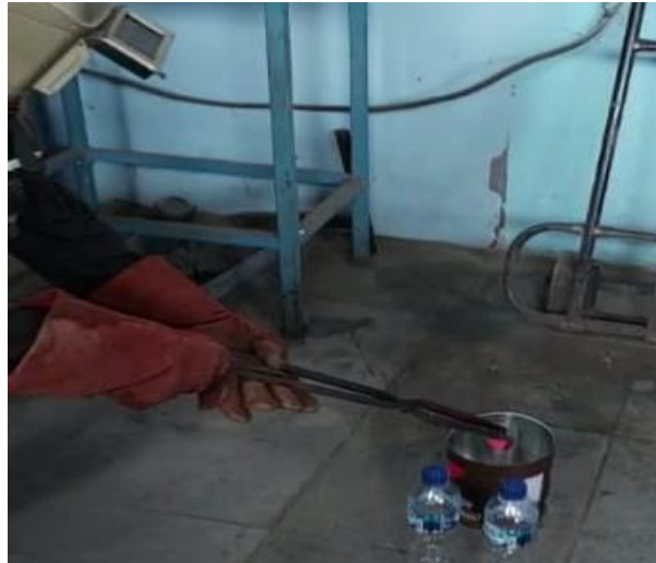
Gambar 3. 14 Pengambilan Spesimen Dari Tungku Pemanas (Sumber: Lab. Teknik Mesin UPS)
