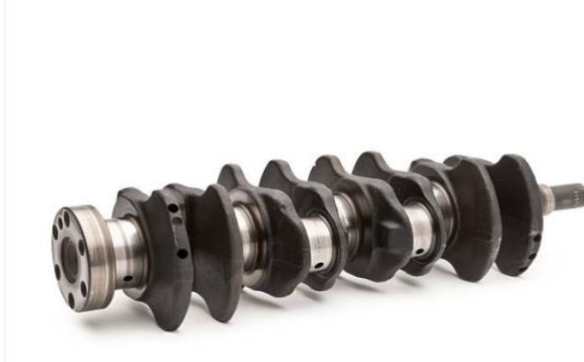
Gambar 2. 2 Contoh Penggunaan Baja Karbon Menengah Pada Crunkshats, Schlol, (2011)
