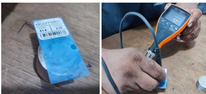
Gambar 4. 37 Kalibrasi alat elcometer digital
