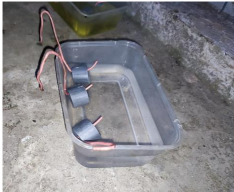
Gambar 4. 30 Pencelupan spesimen ke aquadest setelah proses elektroplating
