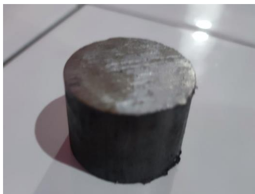
Gambar 4. 3 Hasil pemotongan baja ST-41
