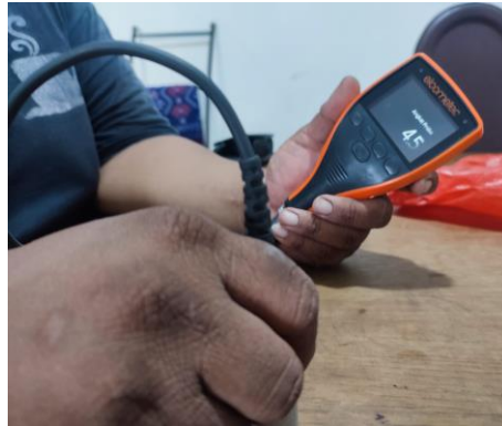
Gambar 4. 43 Nilai ketebalan lapisan zinc variasi waktu 4 menit titik 3
