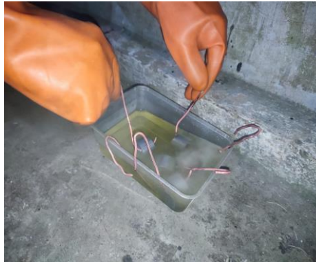
Gambar 4. 15 Pencelupan spesimen variasi waktu 2 menit ke dalam larutan HCl
