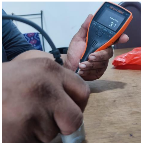
Gambar 4. 35 Pengujian ketebalan lapisan menggunakan elcometer digital 456B
