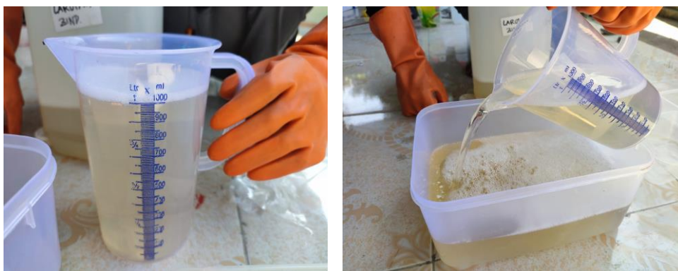
Gambar 4. 11 Larutan zinc acid di gelas ukur dan penuangan ke bak elektrolit
