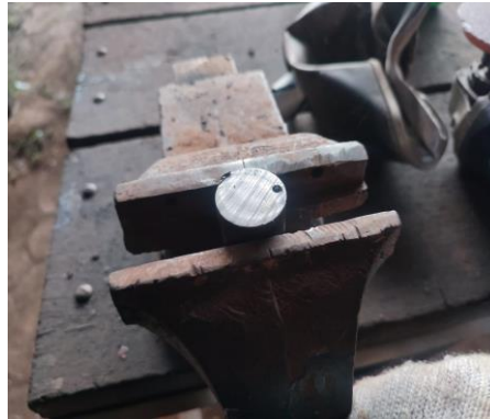
Gambar 4. 6 Spesimen dicekam pada ragum
