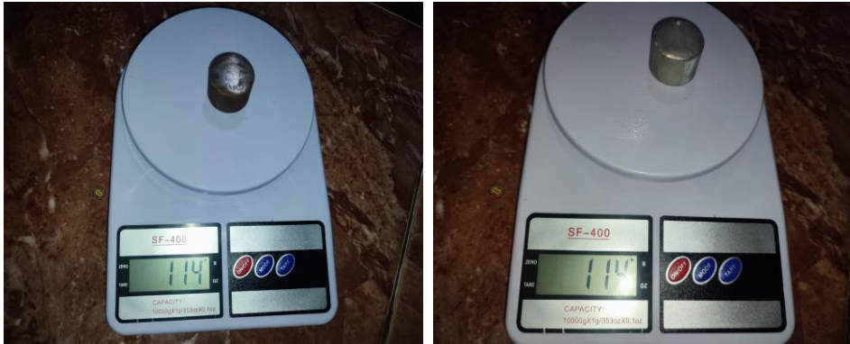
Gambar 4. 38 Spesimen baja sebelum di lakukan pelapisan dan sudah di lakukan pelapisan selama 2 menit
