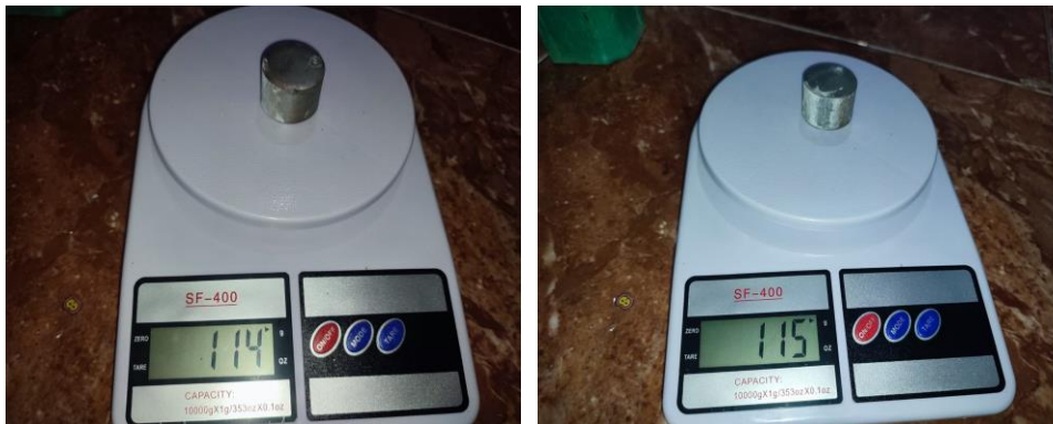
Gambar 4. 39 Spesimen baja setelah di lakukan pelapisan selama 4 menit dan 6 menit
