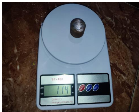
Gambar 4. 19 Pengukuran berat spesimen sebelum di elektroplating
