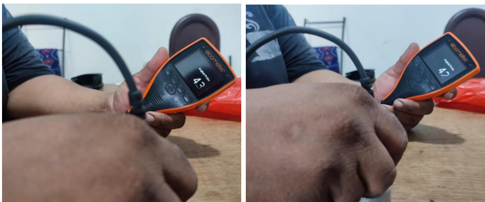
Gambar 4. 42 Nilai ketebalan lapisan zinc variasi waktu 4 menit titik 1 dan titik 2
