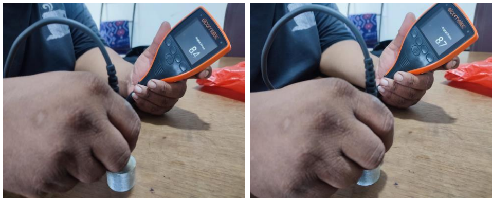
Gambar 4. 44 Nilai ketebalan lapisan zinc variasi waktu 6 menit titik 1 dan titik 2
