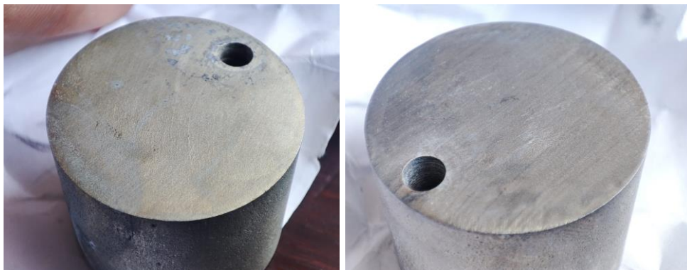
Gambar 4. 34 Spesimen dilapisi selama 4 menit dan 6 menit
