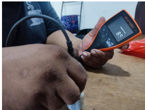
Gambar 4. 45 Nilai ketebalan lapisan zinc variasi waktu 6 menit titik 3
