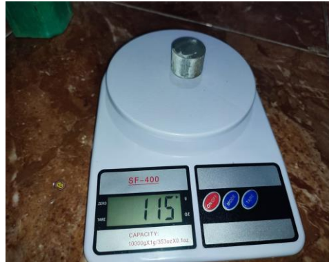
Gambar 4. 32 Pengukuran berat spesimen setelah di elektroplating
