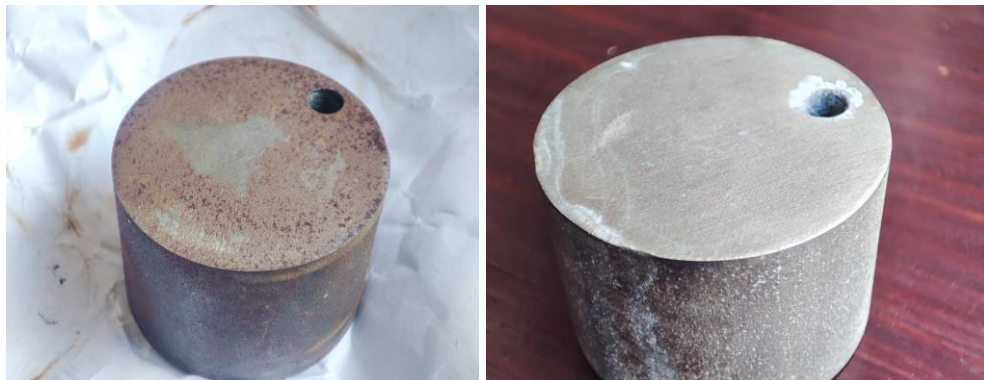
Gambar 4. 33 Spesimen sebelum dilapisi dan sesudah dilapisi selama 2 menit
