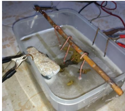
Gambar 4. 25 Elektroplating waktu 2 menit
