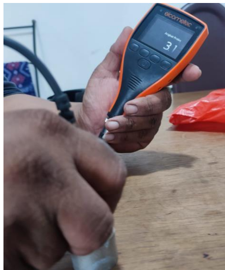
Gambar 4. 41 Nilai ketebalan lapisan zinc variasi waktu 2 menit titik 3
