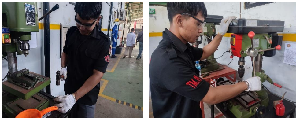
Gambar 4. 4 Penitikan dan pelubangan spesimen
