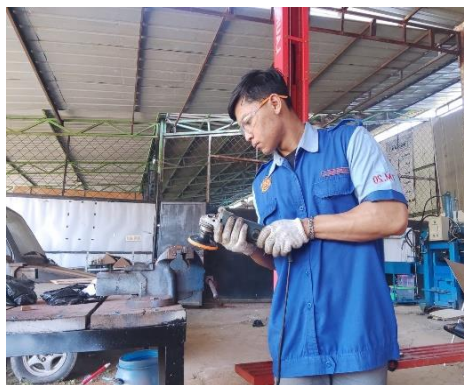
Gambar 4. 7 Proses pengamplasan spesimen
