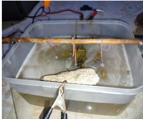
Gambar 4. 27 Elektroplating waktu 6 menit
