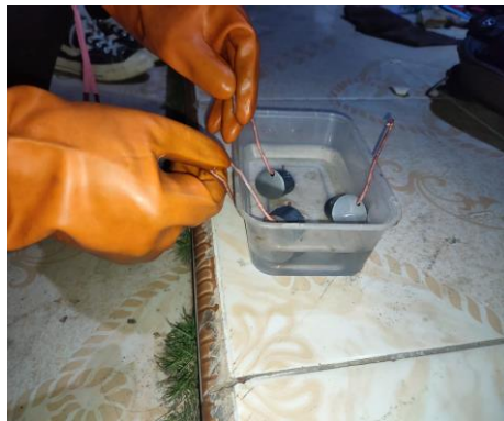
Gambar 4. 18 Pembelisan spesimen menggunakan aquadest
