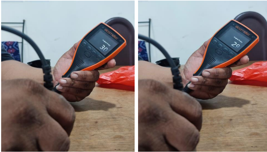
Gambar 4. 40 Nilai ketebalan lapisan zinc variasi waktu 2 menit titik 1 dan titik 2
