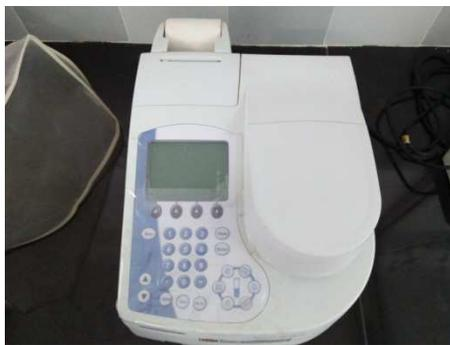
**Gambar 2.3 Spektrofotometri UV-Vis (Dokumentasi pribadi, 2021)**
