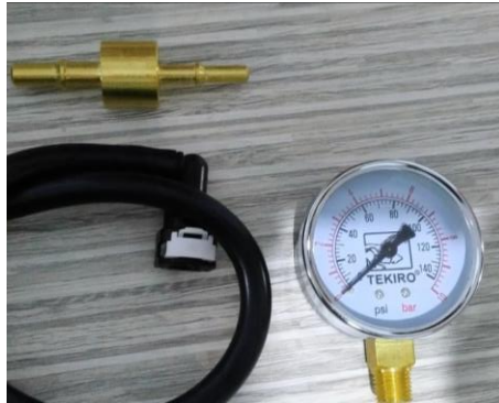
Gambar 3. 18 Pressure Gauge dan Nepel Injektor
