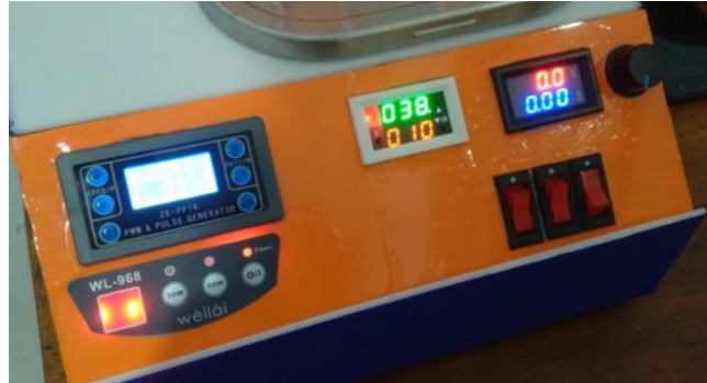
Gambar 4. 14 Proses pengecekan rangkaian kelistrikan
