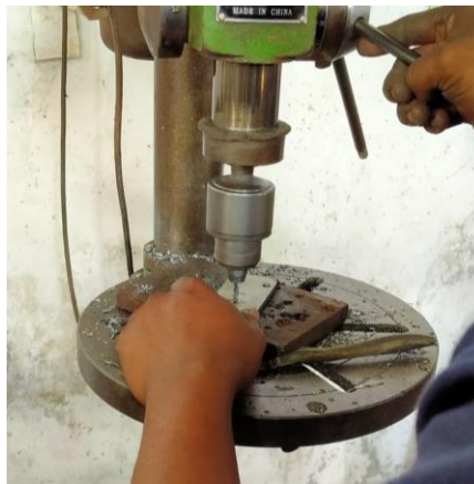
Gambar 4. 22 Proses pelubangan untuk dudukan penjepit
