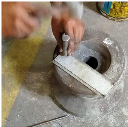
Gambar 4. 20 Pembuatan titik menggunakan penitik
