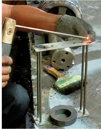
Gambar 4. 23 Proses pengelasan as dengan plat
