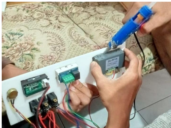
Gambar 4. 11 Proses pengeleman komponen pada dudukan
