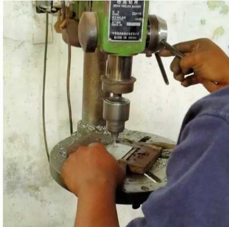
Gambar 4. 21 Proses pelubangan plat
