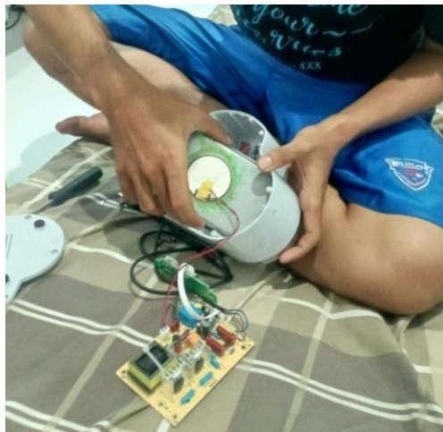
Gambar 4. 5 Proses pembongkaran ultrasonik cleaner
