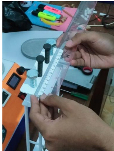
Gambar 4. 49 Proses uji dimensi plat bagian atas
