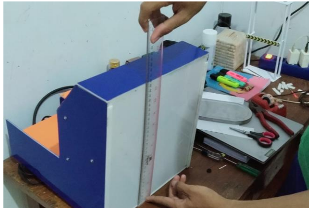
Gambar 4. 31 Proses Uji dimensi body sisi bawah
