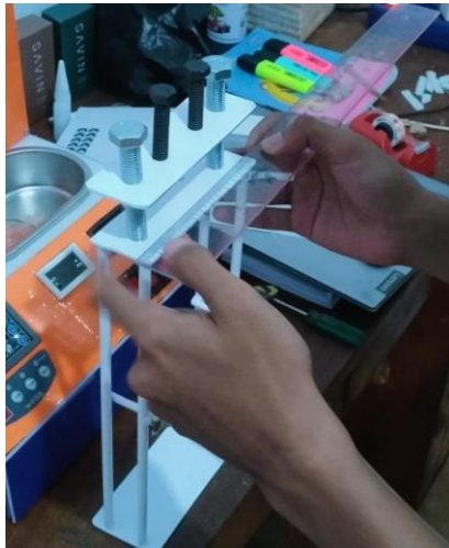
Gambar 4. 52 Proses uji dimensi plat besi bagian tengah untuk injektor tester
