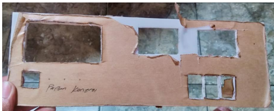
Gambar 4. 7 Proses pelubangan papan kontrol
