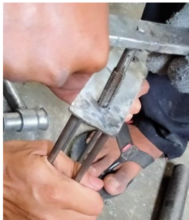
Gambar 4. 24 Proses pembuatan tap
