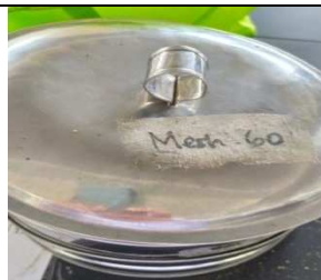
Pengayakan serbuk bawang daun yang sudah halus menggunakan ayakan mesh 60
