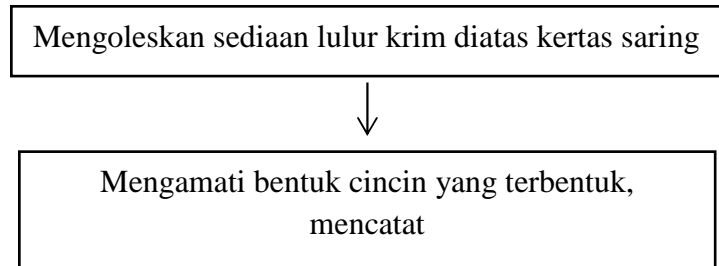
Gambar 3. 12 Skema Uji Tipe Krim dengan metode cincin (Progestin, 2018)
