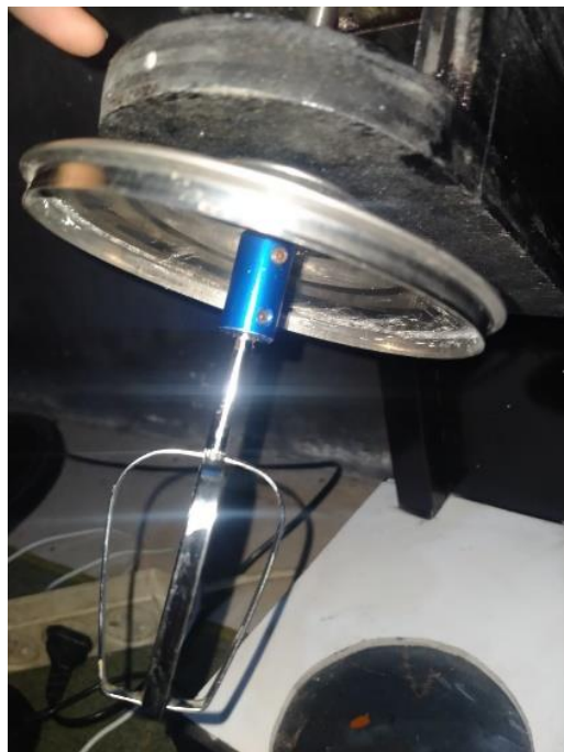
Gambar 5.7 Pemasangan alat pengaduk
