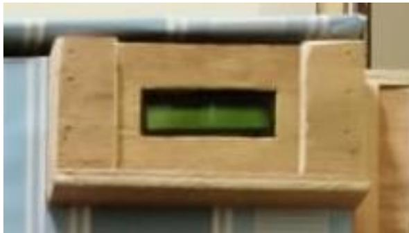
Gambar 5.6 Pemasangan LCD 16x2
