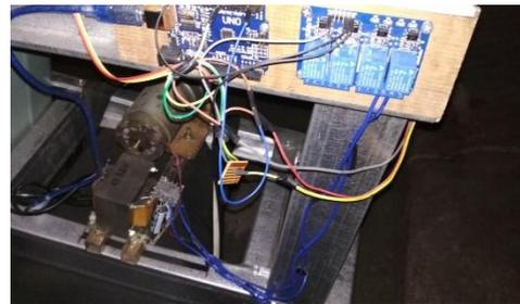
Gambar 4. Arduino, Relay, Trafo dan Sensor Inframerah sudah terpasang
