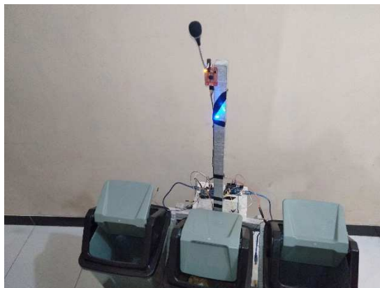
Gambar 5.3 Tampilan LED pada saat sampah telah terisi penuh
