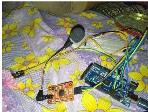
Gambar 5.2 Rangkaian Sensor voice recognition pada Prototype Tempat sampah pintar menggunakan perintah suara berbasis web.
