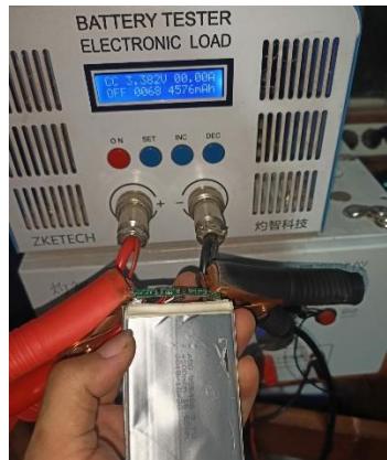
Gambar 4.10 Megecek hasil keseluruhan baterai
