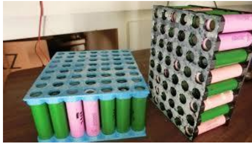
Gambar 4.5 Pemasangan Holder pada baterai
