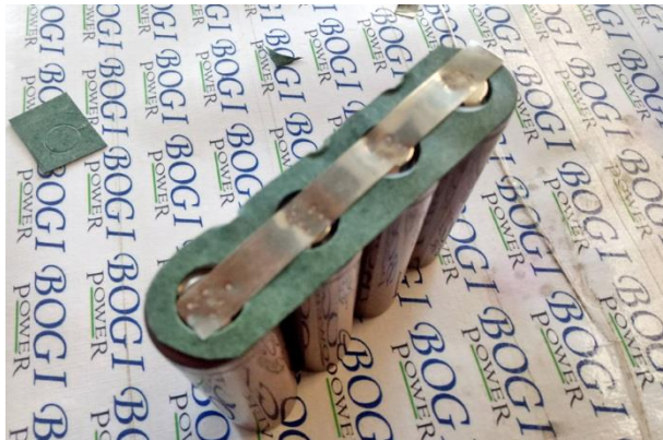
Gambar 4.6 Pemasangan Isolator cell pada baterai
