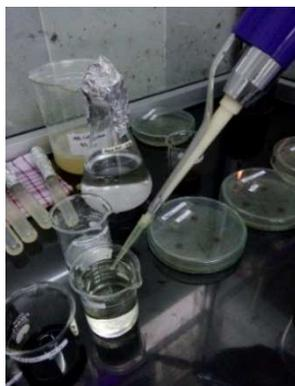
Mensterilkan mikropipet dengan etanol sebelum digunakan untuk memasukan ekstrak
