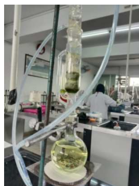
Gambar 4.2 Ekstraksi dari metode Sokletasi
