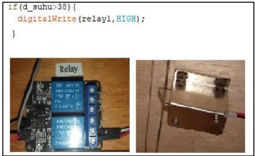
Gambar 10 Relay dalam kondisi off
