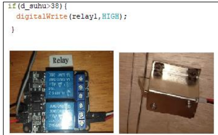
Gambar 5. 7 Relay dalam kondisi off
