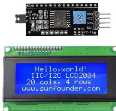
Gambar 2.11 Bentuk Fisik LCD I2C
